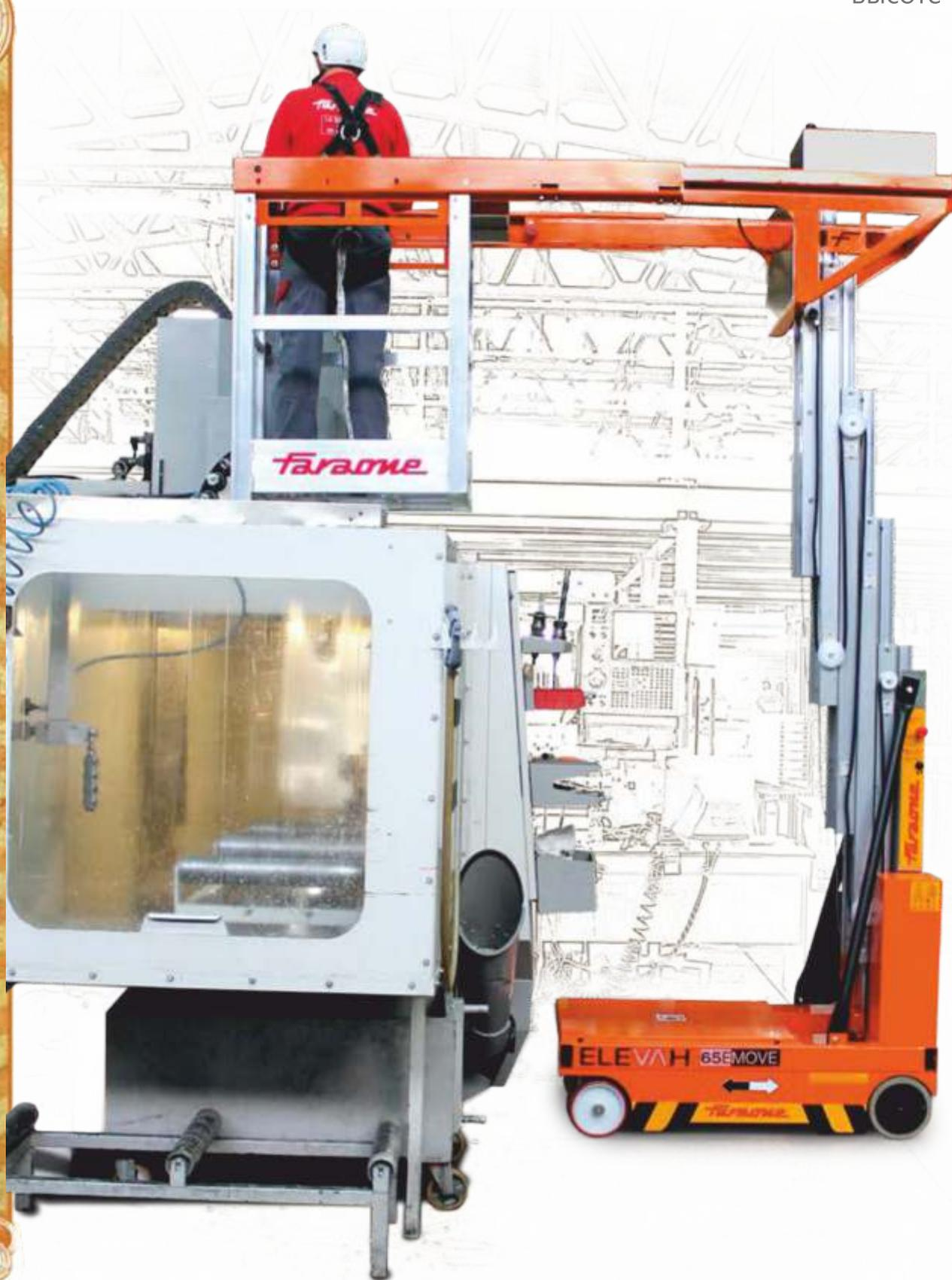
Способен передвигаться даже на максимальной высоте 7,56 м.
