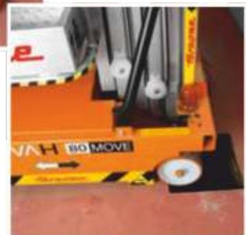
Способен передвигаться даже на максимальной высоте 7,75 м.
