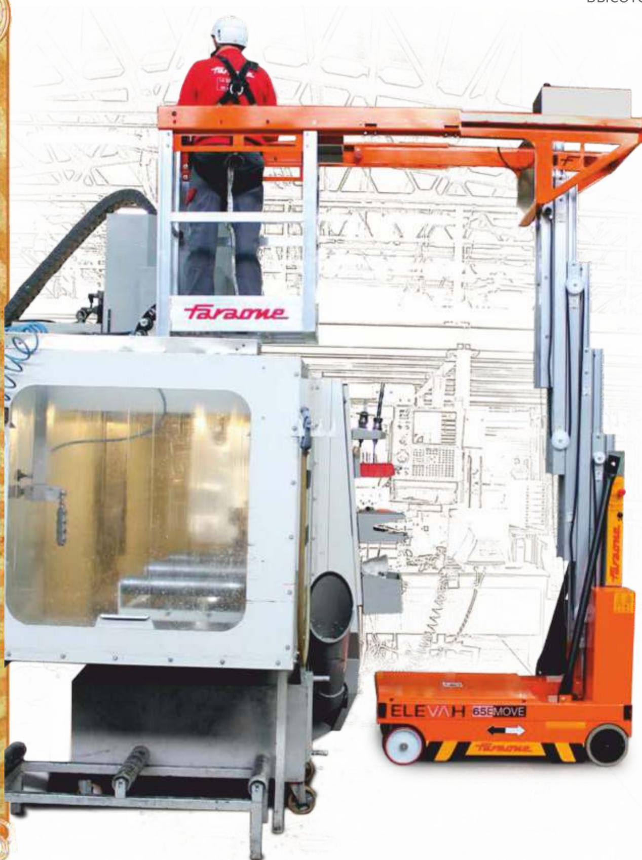
Способен передвигаться даже на максимальной высоте 6,7 м.
