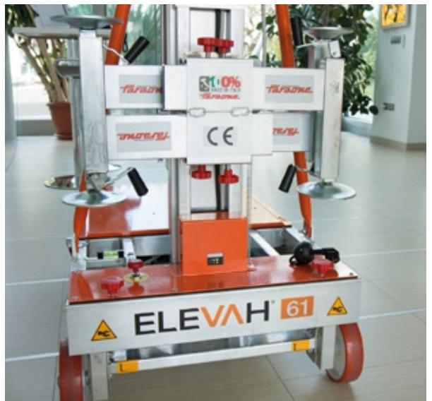
Возможно внешнее использование подъемника с расширенными стабилизаторами.
