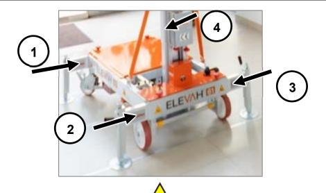
INSTALL THE STABILISING FEET IN ORDER TO REACH THE MACHINE'S MAXIMUM
